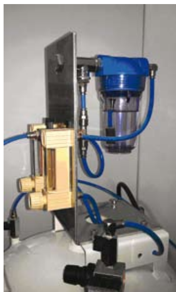
Сл. 11 Систем за овлаживање гаса са дестилованом водом Fig. 11 The system of gas humidification with distilled water
