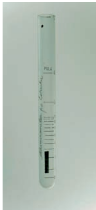
Сл. 9 Албуминометар (Кат. бр. 15) Fig. 9 Albuminometer (Cat.No. 15)
