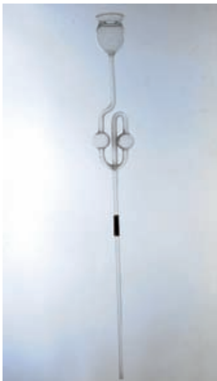
Сл. 16 Цев са две кугле (Кат. бр. 27) Fig. 16 Thistle funnel with two bulbs in loop (Cat.No. 27)
