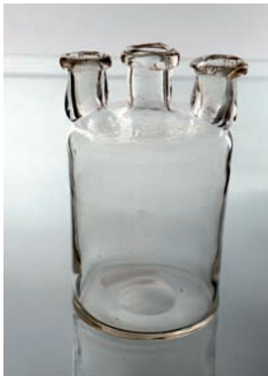
Сл. 13 Посуда са три грла (Кат. бр. 3) Fig. 13 Three neck flat-bottom flask (Cat.No. 3)
